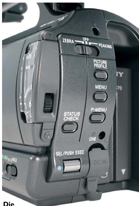
Die Rückseite des FX1 trägt die Tasten für Picture Profile und P-Menu (oben). Unten: Die analogen Buchsen des FX1.
